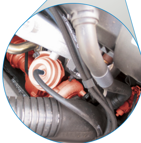
Convertidor de presión y cargadores VTG (resaltado en rojo) en el Audi A4 TDI
